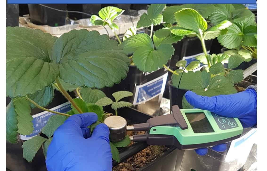
Imagen 2. Lectura del contenido en clorofila y flavonoides con el clorofilómetro DUALEX
